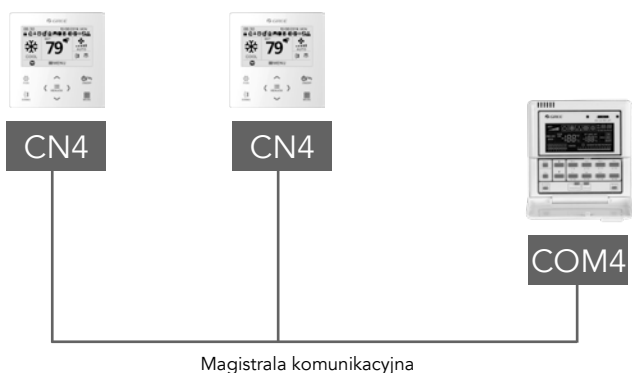
Okablowanie komunikacyjne sterownika centralnego
