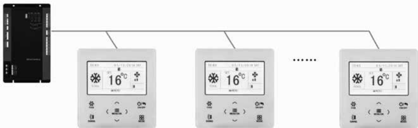
Schemat instalacji komunikacji bramki BACnet - sterowniki XK76
